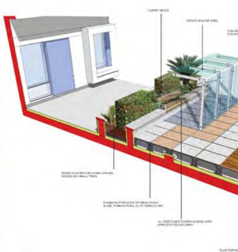
爱德华国王纪念医院是百慕大地区首先采用绿色屋顶的项目，在减少建筑物屋面反射光的同时，还有助于提高建筑物的隔热性能并在热带风暴期间保护屋面结构免受飞溅碎石的影响。
