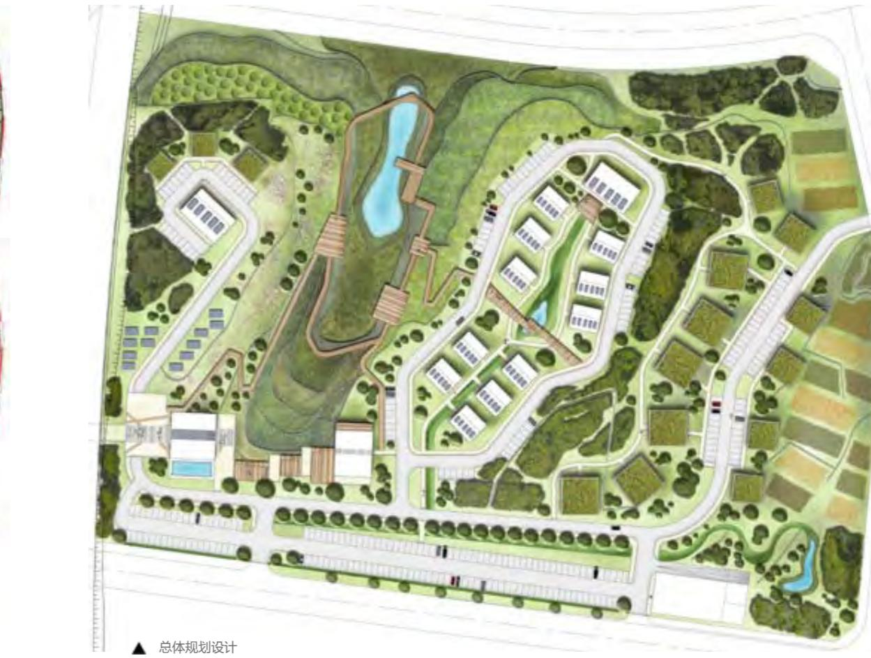
现状场地特征被尽可能的保留利用，比如场地上历史悠久的茶田，被保留下不仅作为景观元素，也作为地表水径流到达泻湖湿地前的生物净化系统，同时也是补充地下水维持地下水水位的渠道。场地将灰水、黑水和黄水分系统处理以保证所有水资源都能在场地内循环回收。例如黑水、黄水中的生物固体和硝酸盐就被分离提取，作为梯田农作物生长的肥料。
